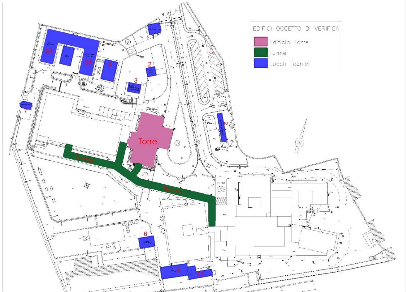
Edifici oggetto dei lavori di adeguamento sismico
